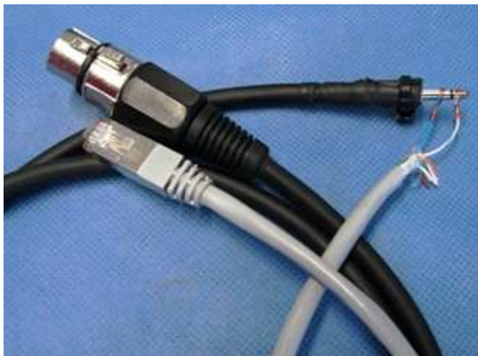
La chapuza de conexión a cable pelado
