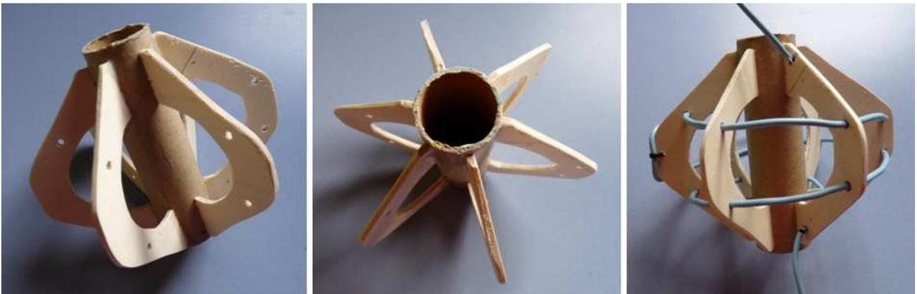
Al ensayar este modelo me da una ROE en torno de 2,5, confirmando que al añadir el segundo elemento ha subido la Impedancia (en torno a 100 ohmios). La solución pasa por añadir un tramo de cuarto de onda hecho con coaxial de 75 ohmios en serie con el de 50 ohmios.
