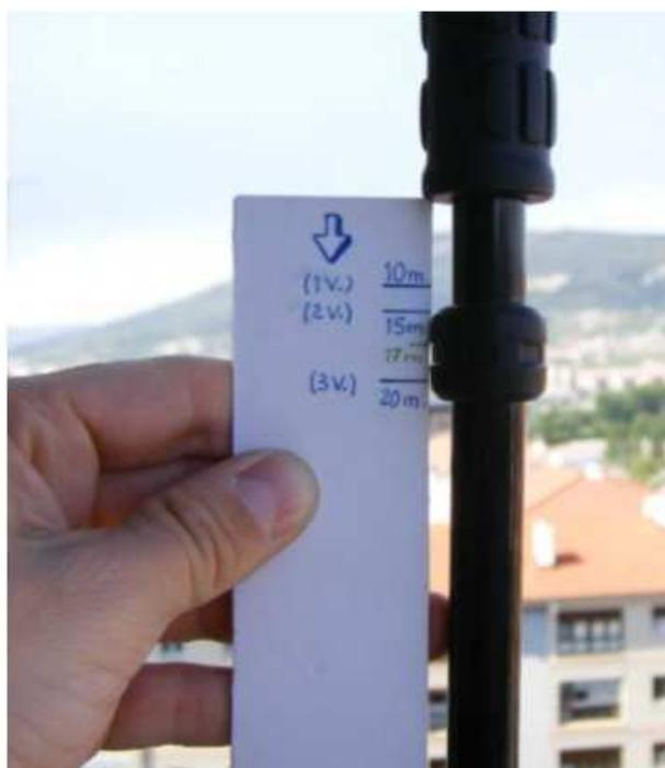
Colocación del cartón en la base de la bobina para ajuste manual de altura (ej: 15m).
