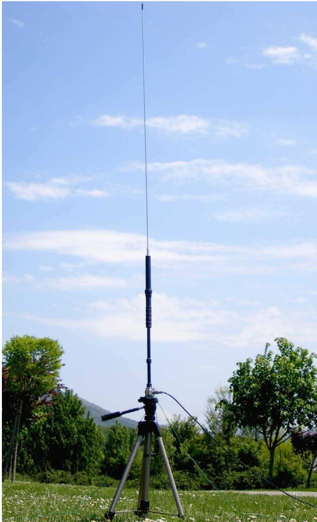
Dí con la Yaesu ATAS-25, una pequeña antena vertical multibanda compuesta de un pequeño radiante y una bobina en la base. La antena plegada y embalada ocupaba tan solo 60 cm. lo cual facilitaba enormemente su portabilidad.
